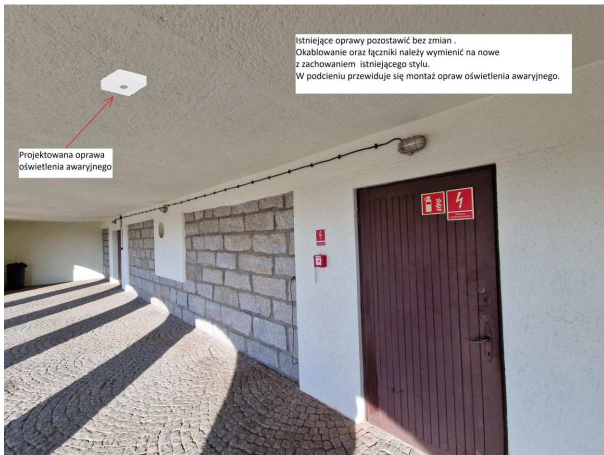
Rysunek 6. Oprawy oświetlenia wejść do piwnicy niepodlegające wymianie.
